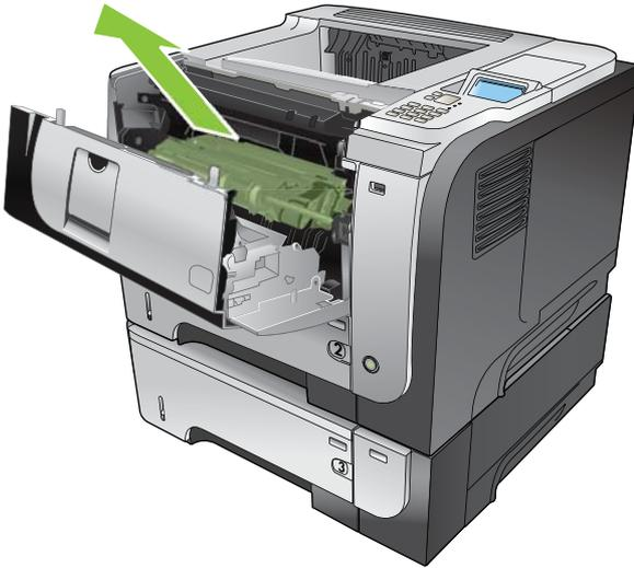
3. Nehmen Sie die neue Druckpatrone aus der Schutzverpackung. Legen Sie die verbrauchte Druckpatrone in die Schutzverpackung, damit sie recycelt werden kann.
