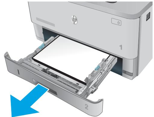
2. Entfernen Sie das Papier aus dem Fach, und entsorgen Sie beschädigtes Papier.
