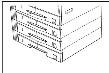
**HINWEIS:** Das 16-S./min-Modell kann mit drei zusätzlichen Kassetten, das 20- und 25-S./min-Modell mit zwei zusätzlichen Kassetten ausgestattet werden.
