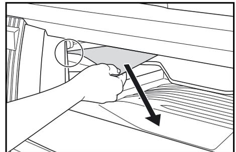
Papier beim Entnehmen nach unten ziehen, um eine Beschädigung zu vermeiden.
