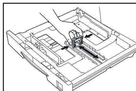
Bei A3 (11 x 17 Zoll (Ledger))-Papier die Längenführung ganz nach rechts schieben und nach unten drücken.
