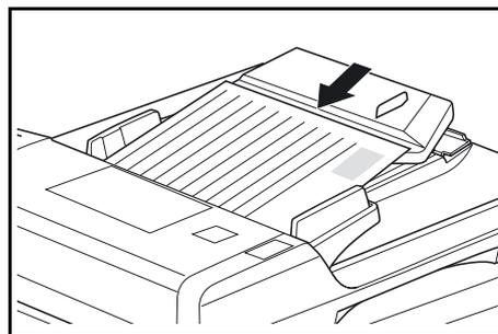
**WICHTIG:** Zur Vermeidung von Fehleinzügen darf der Originalstapel die Maximalmarkierung an der hinteren Föhrung nicht übersteigen.
