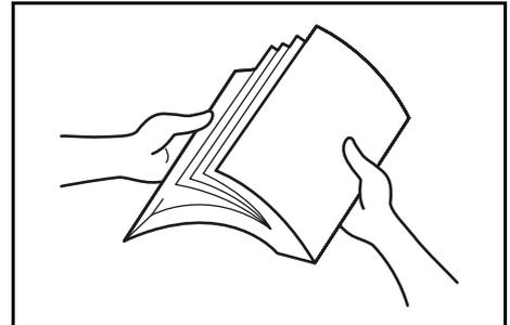
Bei Kassetten Papier mit der Seite, die zur Verpackungsoberseite weist nach unten, bei der Universalzufuhr nach oben einlegen.
