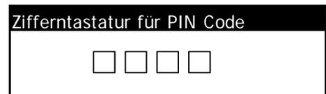
**HINWEIS:** Die werkseitige Voreinstellung des PIN-Codes ist modellabhängig: 16-S./min-Modell = 1600, 20-S./min-Modell = 2000, 25-S./min-Modell = 2500. Dieser Code kann beliebig geändert werden. (Weiteres hierzu siehe *Bedienungsanleitung*, Kapitel 3.)
