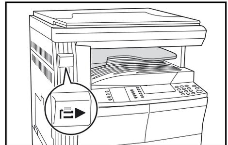
Befindet sich Papier im Auftragstrennfach, leuchtet die entsprechende Anzeige an der Gerätevorderseite auf.
