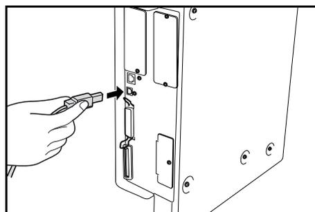
**HINWEIS:** USB-Kabel müssen dem USB-Standard (Version 2.0) entsprechen (rechteckiger Stecker vom Typ A, quadratischer Stecker vom Typ B). Das USB-Kabel muss abgeschirmt und darf nicht länger als 5 Meter sein.
