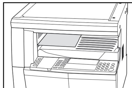
**HINWEIS:** Das Ausgabefach fasst bis zu 250 Blatt Standardpapier (80 g/m<sup>2</sup>). Wird Papier eines anderen Gewichts verwendet, ist die Kapazität entsprechend größer oder geringer.
