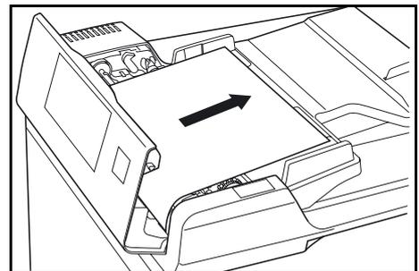
**HINWEIS:** Reißt das Papier während der Staubeseitigung, sämtliche Papierteile aus dem automatischen Vorlageneinzug entfernen, um einen Fehleinzug der Originale zu vermeiden.
